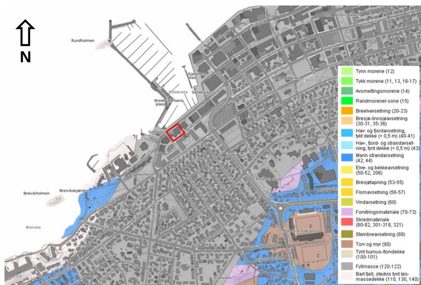
Figur 2-3: Løsmassekart fra planområdet (rødt rektangel) med egnet målestokk 1:50 000. Kartet indikerer et øvre løsmassedekke av antatte fyllmasser (grå). Langs kystlinjen til vest er det i hovedsak angitt bart fjell med stedvis tynt løsmassedekke (lys rosa) og marine strandavsetninger (blå) (kilde: geo.ngu.no/kart/losmasse_mobil).
