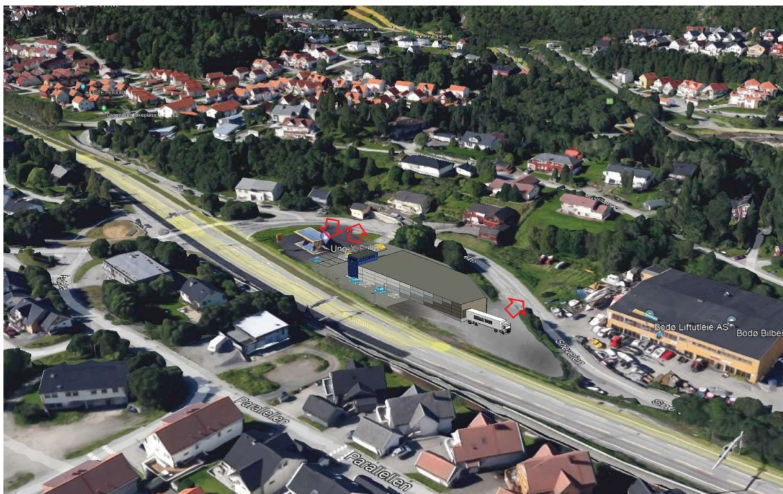
Figur 23. Planlagt utbygging for ny nærbutikk. Perspektiv fra SØ. Eksisterende bensinstasjon i vest og ny nærbutikk i øst. Inn- og utkjørsel fra Sneveien i vest og utkjørsel for varelevering til Sneveien i øst. 3D-skisse REMA 1000, mars 2020.
