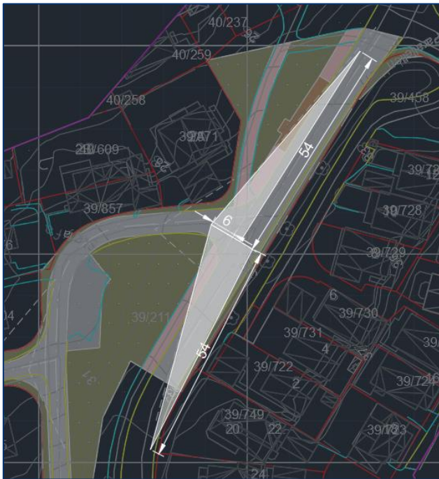
Figur 8 – Siktretkanter kryss Fogdveien/Sløyfa
