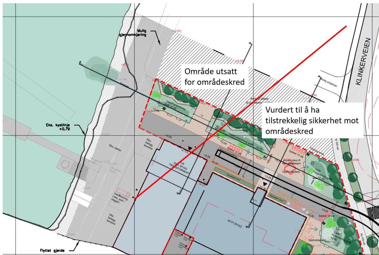
Figur 3-1: Utklipp fra landskapsplan som viser ca. plassering av mudret molo, og hvilket område som må utredes for områdeskred iht. prosedyre. Merk at plassering av molo er basert etter beste skjønn basert på grunnundersøkelser.
