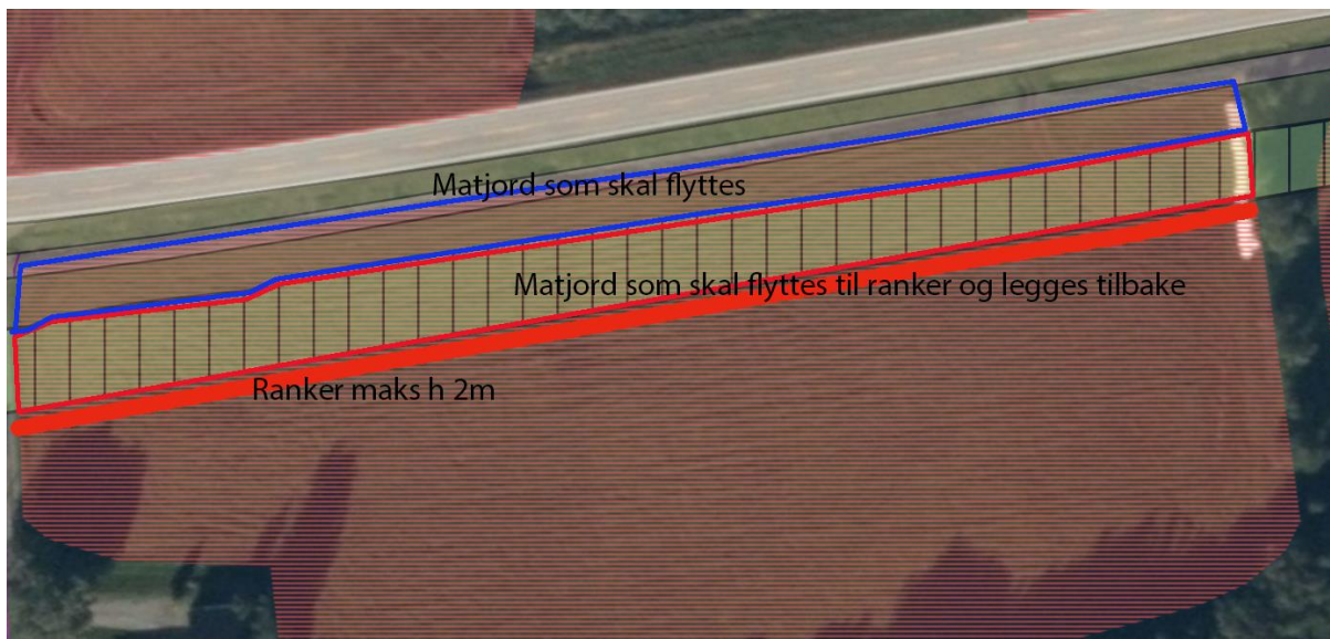
Figur 9: Dersom det er behov å bruke anleggsbeltet skal matjorden fjernes, mellomlagres og legges i ranker. Disse skal ikke overstige en høyde av 2 m.
