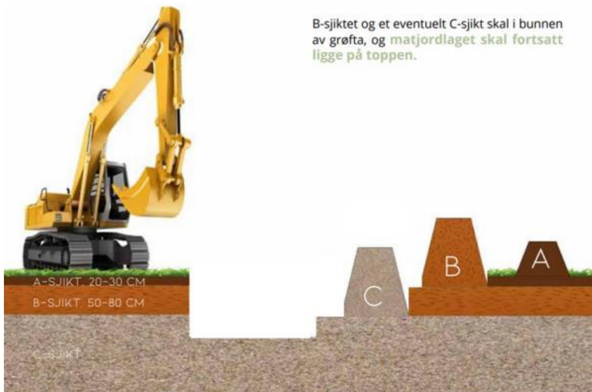
Figur 6.2: Skjematisk bilde viser avtaking av matjord. Med ulike rakner for A-, B- og C-sjikt. Det er en fordel dersom A- og B-sjikt kan fjernes der gravmaskinen skal operere.
