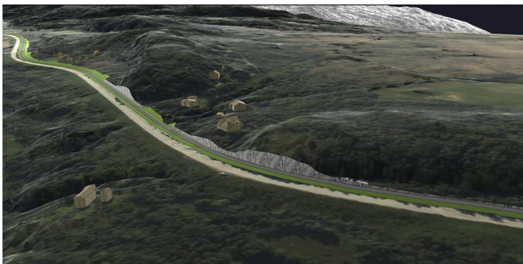
Figur 10.20: Bilde av vegmodellen som viser de lange og store bergskjæringene som alternativ sør medfører.
