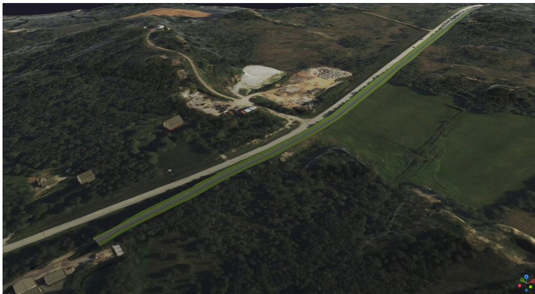
Figur 10.22: Modellbildet viser det søndre alternativet med kryssing over åker- og myrområdene og kobles til eksisterende lokalvegnett.
