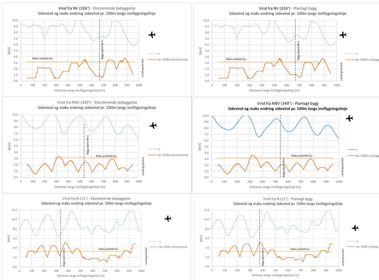
Figur 14. Sammenligning individuelle simuleringer av sidevindkomponent og maksimal endring sidevind pr. 100m langs innflygningslinje.
