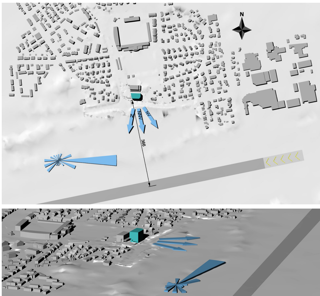
Figur 6. Lokalisering av planlagt nybygg (grønt) i forhold til rullebane og landingsterskel-øst, samt vindrose for Bodø lufthavn. Valgte vindretninger for analyse er angitt med blå piler (mål i meter).
