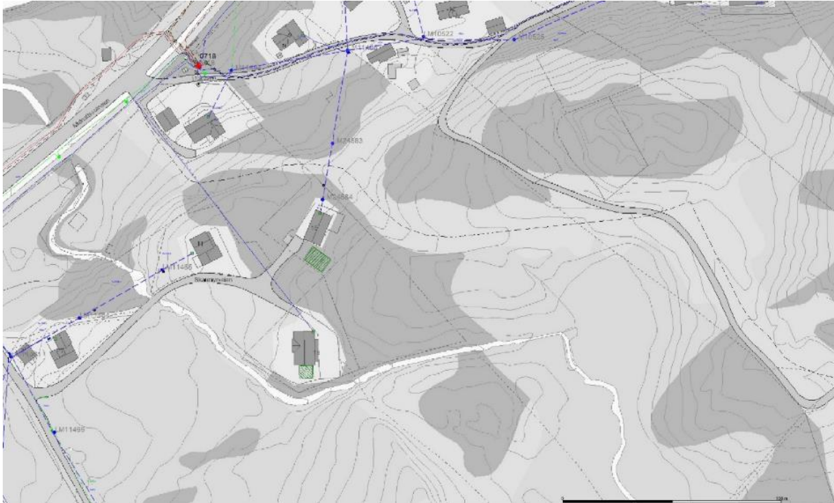
Figur 26. Husåsen Vest. Oversikt over el-ledninger. Rød storstiplet fra stolpe til stolpe: høyspent luftstrek. Blå heltrukket: 400 eller 230 V kabel lavspent. Blå storstiplet fra stolpe til stolpe: lavspent luftstrek. Lys grønn heltrukket: gatelyskabel. Kilde Arva mai 2022.
