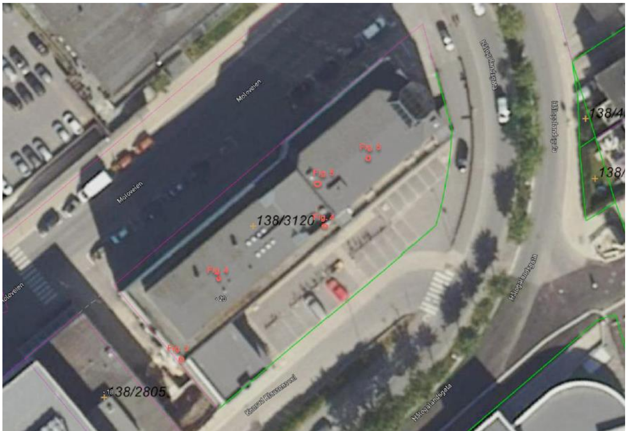
Figur 3: Innmålinger er vist fra vest mot øst (NN2000): 20,41, 22,57, 25,30, 25,97 og 25,54. alle høyder er vist som kote + moh.
