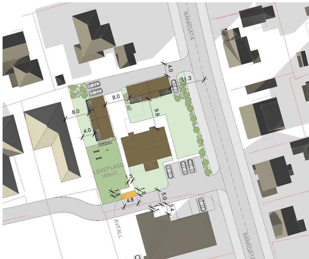
Figur 13. Illustrasjonsplan med ny bebyggelse som to bygg, lekeplassen mot sydvest og felles adkomstvei med tannklinikken. BOARCH mars 2023
