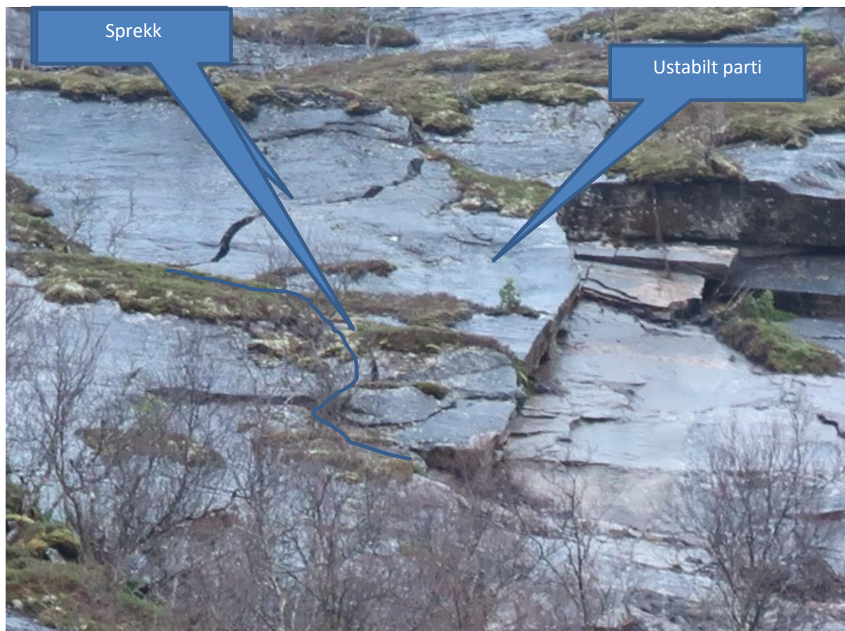
Figur 6: Ustabilt parti ved siden av antatt løснеområde, se fig 3, den blå påtegnede markeringen er tegnet tett til venstre for sprekken for å vise forløpet.
