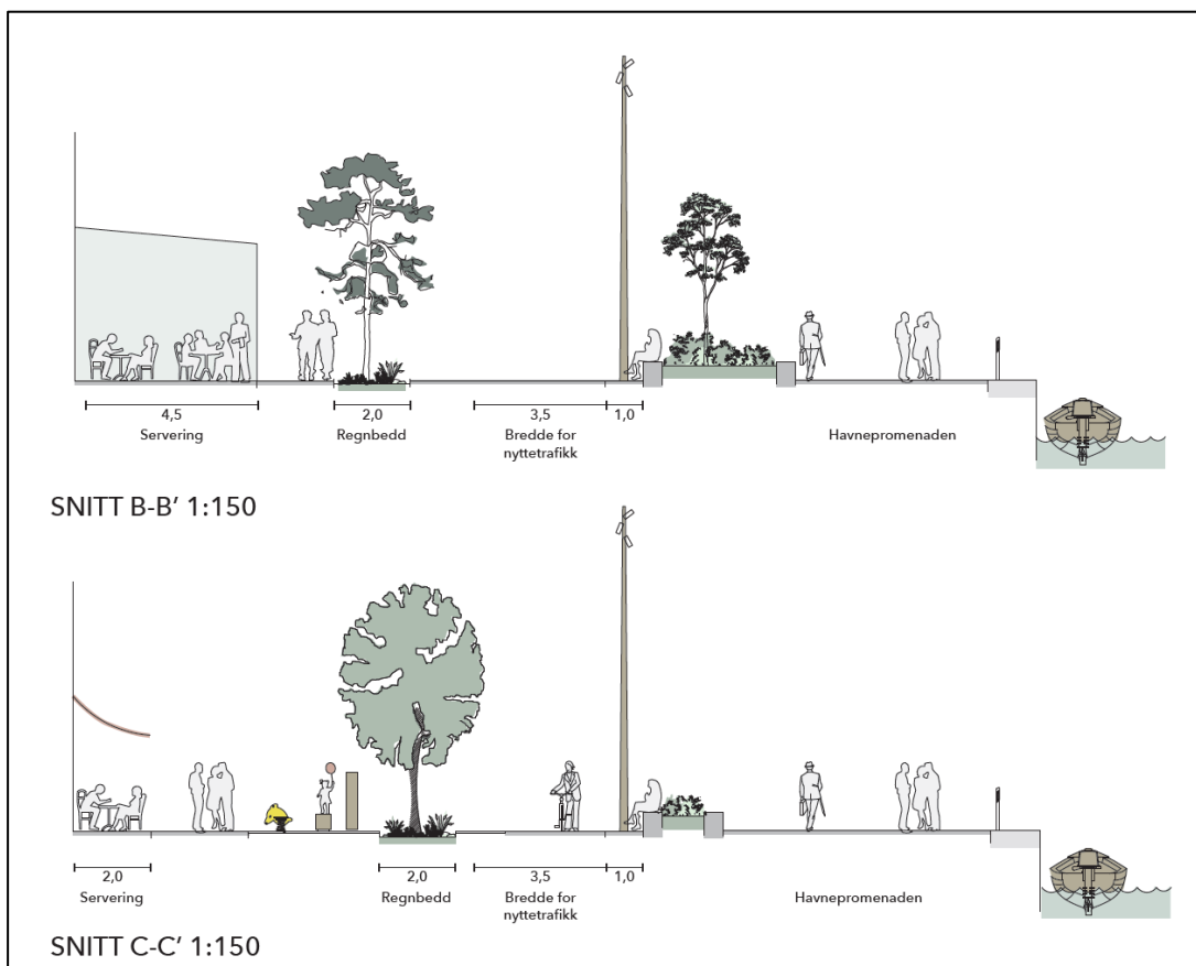
Figur 8: Figuren viser snitt fra figur 6. Målestokk er ikke korrekt da bildet er forminsket (illustrasjon: White og KOHT Arkitekter).
