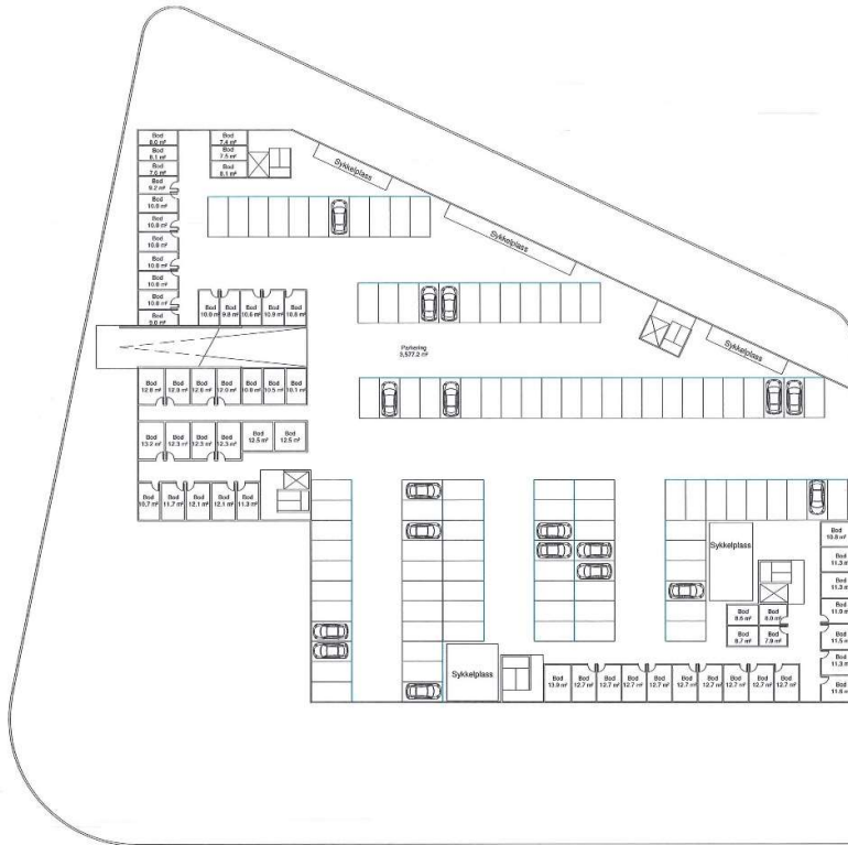
Figur 35. Illustrasjonsplan/situasjonsplan for kjelleretasje med parkering og boder. Nedkjøringsrampe fra Gjerdåsveien, i øst. Tegning BOARCH arkitekter a.s desember 2020.
