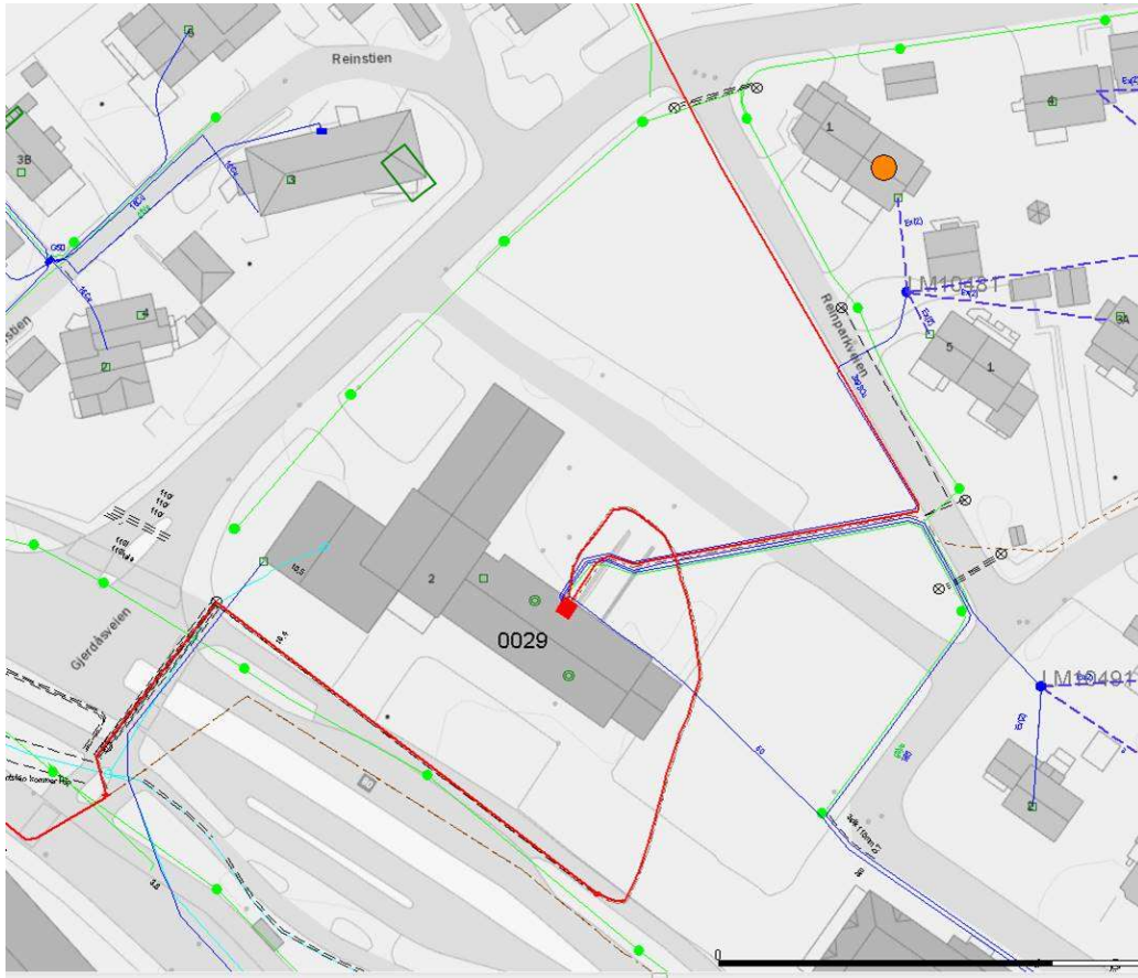
Figur 23. Oversikt over el-anlegg i området. Fra Nordlandsnett.
