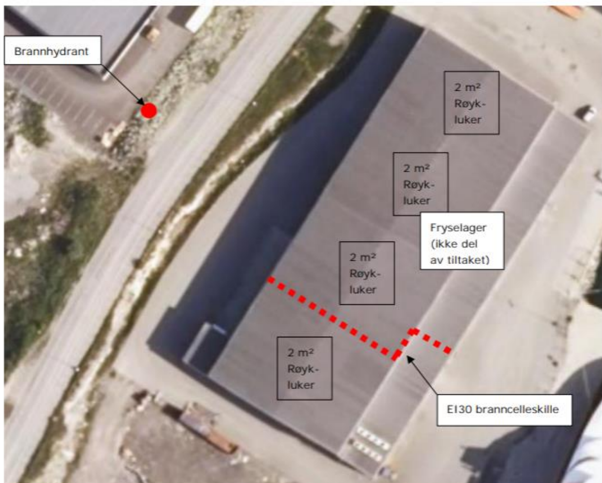
Figur 3 - Brannskisse/prinsippskisse for hele bygget (lager).
