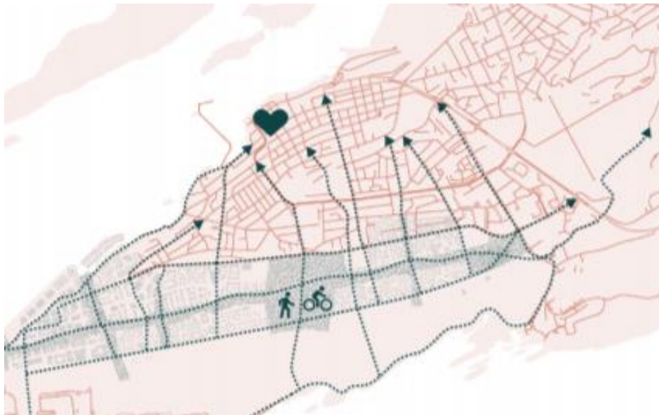
Figur 27 Forlengelse av viktige gatestrukturer i eksisterende by inn i ny bydel for myke trafikanter, med kobling mot sentral grøntstruktur. (Parallelloppdrag Asplan Viak, 2020).
