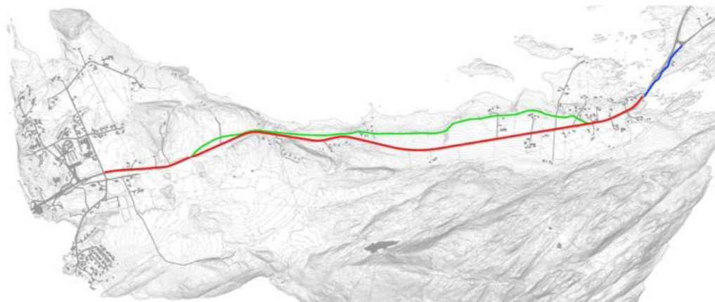
Figur 2: Utklipp fra mulighetsstudiets rapport viser illustrasjon av de tre alternativene ved Fv. 17; standardløsning nord (rød), landskapstilpasset (grønn) og standardløsning sør (rød og blå) [4].
