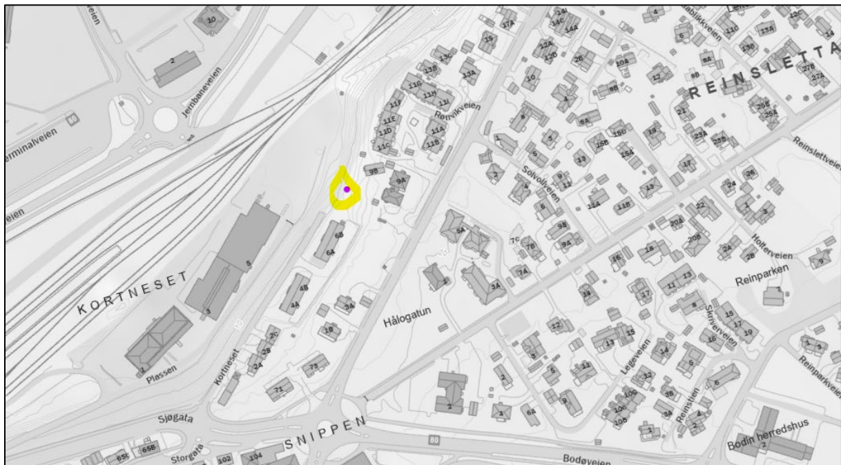
Figur 6: Figuren viser borehullet som i NADAG er borehull med påvist kvikkleire. Borehullet ligger i skråningen ned mot jernbaneområdet. Det er ellers ikke påvist kvikkleire i, eller i nærheten av planområdet.
