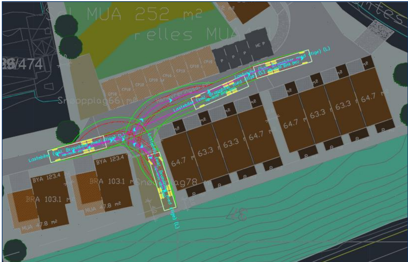
Figur 23 - Snuing av 12 m lastebil på adkomstveg
